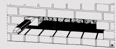
Binder-(Kopf-)-steine über der Läuferschicht abschlagen.
